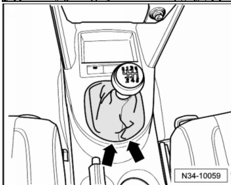
Застопорить рычаг переключения передач:
